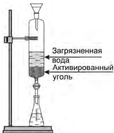
Установка для очистки воды адсорбцией
